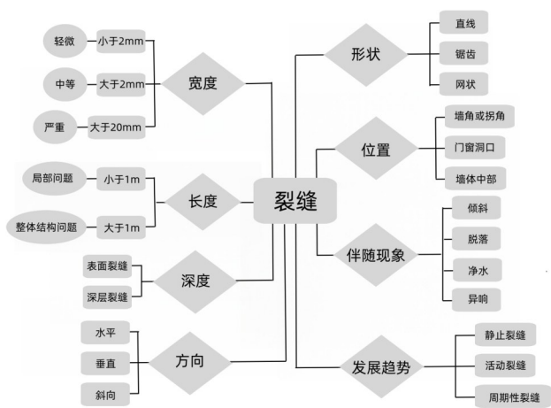
图4 裂缝分析图
